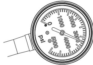
*Il est recommandé d'utiliser un manomètre submersible (SPG) de secours*
