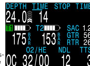
Le réglage de notification de changement de bloc peut être configuré entre 7 et 69 bar, ou 100 et 999 PSI.
