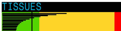
Le bargraphe des tissus montre les tensions des gaz inertes dans les compartiments de tissus, sur la base du modèle Bühlmann ZHL-16C.
