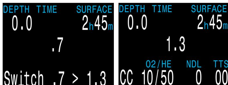
Lors des plongées en circuit fermé, le Perdix 2 fonctionne en mode PPO<sub>2</sub> interne. Ce mode permet de calculer la décompression pour un recycleur qui n'est pas connecté à l'ordinateur.
