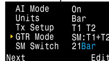
Le TGR et la CAS prennent en compte un seul bloc, ou deux blocs en configuration sidemount. Notez qu'en configuration sidemount, les deux blocs doivent avoir un volume identique pour garantir une valeur CAS correcte.
