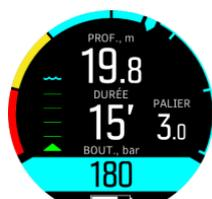
Dans la fenêtre commutable, la pression actuelle est affichée par défaut dans une zone bleue. Une flèche bleue indique également la pression sur le pourtour de l'écran. La partie bleue du pourtour indique la plage comprise entre la valeur définie pour l'alarme de pression des bouteilles et la pression actuelle :
