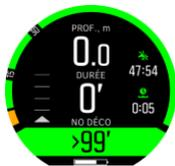
Le temps d'interdiction de vol est la durée d'attente minimum en surface recommandée avant tout vol en avion. Il est toujours d'au moins 12 heures et égal au temps de désaturation lorsque ce celui-ci est supérieur à 12 heures. Pour les temps de désaturation inférieurs à 75 minutes, aucun temps d'interdiction de vol ne s'affiche.
