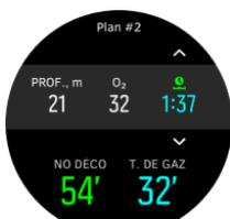
Le temps de décompression calculé est basé sur la profondeur et le mélange gazeux de la plongée. L'azote résiduel des plongées précédentes ainsi que le temps de surface sont pris en considération. Le paramètre **T. de gaz** (Temps de gaz) dépend de la profondeur de plongée, de la consommation personnelle et de la taille et de la pression de la bouteille.
