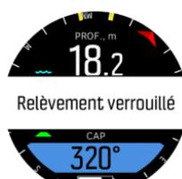
Une fois le relèvement verrouillé, des barres jaunes apparaissent à l'écran et indiquent l'angle de verrouillage du relèvement :
