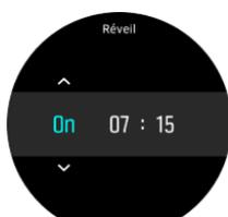
2. Changez de champ avec le bouton central et utilisez les boutons supérieur et inférieur pour régler les heures et les minutes.
