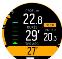
Suunto D5 affiche la valeur du plafond, toujours calculée à partir du plus profond de ces paliers. Les plafonds des paliers profonds et de sécurité se situent toujours à une profondeur constante lorsque vous êtes au palier. La durée d'arrêt est comptée en minutes et en secondes.
