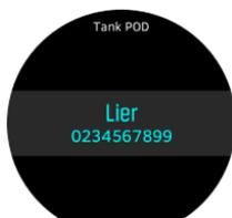
2. Assurez-vous que le Tank POD a été activé, que la pression de la bouteille s'affiche à l'écran et que la valeur est comprise dans la plage souhaitée. Dans le menu, le Tank POD est identifié par le numéro de série imprimé sur le Tank POD.
