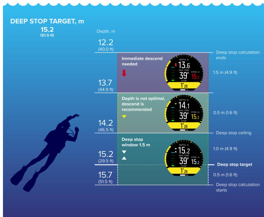
En dessous de 20,0 m (65,6 ft), le palier profond s'active. Dans ce cas, lorsque le plongeur remonte, le palier profond devient obligatoire à la moitié de la profondeur maximale, soit 15,2 m (49,8 ft).
