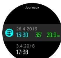
Les détails du journal de plongée et le profil peuvent être parcourus en faisant défiler le journal à l'aide des boutons supérieur et inférieur et en sélectionnant l'option avec le bouton central.
