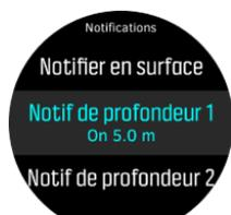
À l'aide du bouton supérieur ou inférieur, sélectionnez Notifier en surface ou Notif profondeur 1, 2, 3, 4 ou 5.
