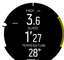
est la vue par défaut. La flèche blanche de située à gauche sur le pourtour de l'écran se déplace en fonction de la profondeur. La partie jaune du pourtour représente la profondeur entre la profondeur maximale (définie par la notification de profondeur 5) et la prochaine notification de profondeur active (la plus profonde).
