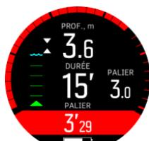
L'exemple suivant montre que le plongeur se trouve à 2,4 m (la profondeur du palier est toujours réglée sur 3,0 m). Il se trouve donc dans la zone du palier, mais au-dessus de la limite. Une flèche jaune vers le bas indique au plongeur qu'il est recommandé de redescendre pour revenir à une profondeur optimale. La profondeur optimale (la profondeur du palier) de 3,0 m est affichée en jaune :
