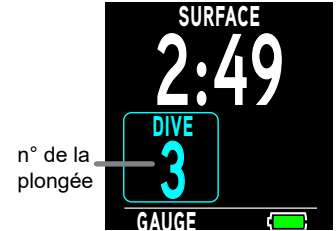
Écran principal du mode surface PROFONDIMÈTRE (> 10 min après la plongée)
