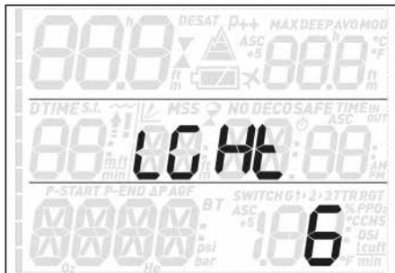
Le Quad Air dispose d'un rétroéclairage qui peut être activé au cas où la lumière ambiante serait faible. Le rétroéclairage est activé par une pression prolongée sur l'un des boutons du haut. Au cours d'une plongée, le rétroéclairage restera activé pendant la durée définie dans ce menu. Vous pouvez choisir une durée de 1 à 10 secondes.
