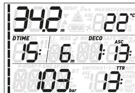
En appuyant sur l'un des boutons du haut, vous pouvez modifier les informations qui s'affichent sur la ligne du haut. À chaque pression de bouton, l'écran fait défiler la température, la profondeur maximale, la profondeur moyenne, la MOD (Nitrox seulement), le palier profond (si activé et s'il est validé par calcul) et un champ vide.
