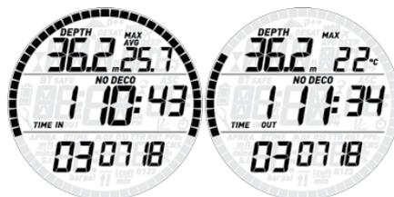
Effectuez une pression prolongée sur le bouton « UP » pour visualiser la page suivante du carnet de plongée, qui affiche l'intervalle de surface avant la plongée alternant avec le temps en plongée et la CNS (alternant entre les valeurs de début et les valeurs de fin) sur la ligne du bas.
