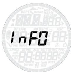
Ce sous-menu vous offre des informations sur la configuration matérielle et logicielle de votre Smart Air, et sur l'état de la pile : **OK** signifie que la pile est bonne, **LO** (faible) que celle-ci s'use, mais peut encore effectuer quelques plongées supplémentaires, et **KO** (mauvaise) que la pile est très faible et que le Smart Air ne pourra pas être utilisé comme ordinateur de plongée.
