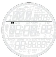
**AIR** est le réglage équivalent à **EAN** sur 21 % et une  $ppO_2max$  de 1,4 bar, mais l'affichage est un peu simplifié puisque la CNS ne s'affiche pas (sa valeur est tout de même calculée, et si nécessaire l'avertissement à 75 % et l'alarme à 100 % se déclenchent).
