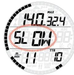
Si la vitesse de remontée est supérieure à 12 m/min à une profondeur plus importante que 12 m, le message **!** (remontée trop rapide) clignote également. Si une vitesse supérieure à 12 m/min est maintenue sur les deux tiers ou plus de la profondeur à laquelle l'alarme a été déclenchée, le Smart Air
