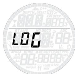
Le Smart Air peut enregistrer les profils d'environ 95 heures de plongée, avec une fréquence d'échantillonnage de 5 secondes. Ces informations peuvent être envoyées grâce au clip USB optionnel vers un PC à l'aide du
