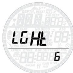
Le Smart Air dispose d'un rétroéclairage qui peut être activé au cas où la lumière ambiante serait faible. Le rétroéclairage est activé en appuyant sur le bouton « **UP** » et en le maintenant enfoncé. Au cours d'une plongée, le rétroéclairage restera activé pendant la durée définie dans ce menu. Vous pouvez choisir une durée de 1 à 10 secondes.
