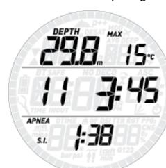
Si vous appuyez sur le bouton « **UP** », l'affichage passe à la profondeur maximale et la température minimale de la séance sur la ligne du haut, le temps de plongée maximal de la séance sur la ligne du milieu et l'heure de la journée sur la ligne du bas. De manière à différencier ce résumé par « séance » du résumé individuel de chaque immersion, les points de la moitié supérieure de l'affichage sont éclairés.
