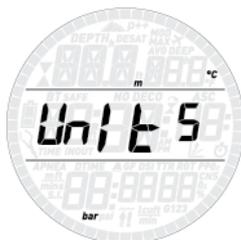
Vous pouvez choisir entre les unités métriques (profondeur en mètres, températures en °C) et impériales. (profondeur en pieds, température en °F).
