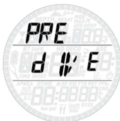
Une pression prolongée sur le bouton « UP » permet d'entrer dans ce menu et met le Smart Air en mode prêt à plonger.
