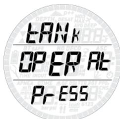
Dans le quatrième menu, **tANK WARN** (alarme de mi-pression), est la valeur à laquelle le Smart Air déclenche un avertissement signalant que le bloc est à la moitié. Cela peut être déterminé individuellement pour chaque bouteille (**G1**, **G2** ou **G3**). Les valeurs par défaut sont de **100 bars** et **1500 psi**.
