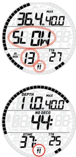
Dans ce cas, si le plongeur essaie de refaire une plongée après être arrivé en surface, le Smart Air ne fonctionnera que comme profondimètre et chronomètre (mode profondimètre), et il affichera !! sur l'écran tout au long de la plongée.
