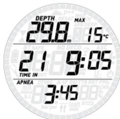
Une pression prolongée sur le bouton « UP » permet d'entrer dans les enregistrements de la séance et de voir la profondeur maximale et température minimale au cours de la plongée sur la ligne du haut, la durée de plongée et sa numérotation séquentielle sur la ligne du milieu, et l'intervalle de surface avant la plongée sur la ligne du bas.
