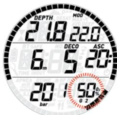
Appuyez sur le bouton « **DOWN** » pour confirmer le passage à G2 : la concentration en oxygène du réglage s'affichera fixement dans le coin en bas à droite de l'écran, et sous 20 secondes la durée de la remontée est mise à jour afin de refléter la plus haute concentration en oxygène du gaz qui est respiré.
