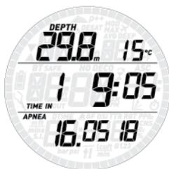
Une pression prolongée sur « UP » appelle la deuxième page du résumé, qui affiche la profondeur maximale et la température minimale de la séance sur la ligne du haut, l'heure à laquelle la séance a commencé et la numérotation séquentielle des immersions sur la ligne du milieu, et la durée de plongée la plus longue de cette séance sur la ligne du bas.
