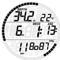
En cas de remontée, la **vitesse** en m/min ou pieds/min est affichée dans le coin en bas à gauche.
