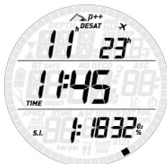
L'affichage post plongée est celui par défaut, à condition qu'il n'y ait ni temps d'interdiction de vol ni désaturation dont la durée soit supérieure à 1 minute. Par une pression sur le bouton « **DOWN** », vous pouvez accéder à tous
