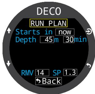
Indiquez l'intervalle de surface prévu dans la case Starts In (Commence dans), Bottom Depth (Profondeur maximale de la plongée), la durée de la plongée, le volume respiratoire par minute RMV (VRM) et le SP (Point de réglage) (circuit fermé seulement).
