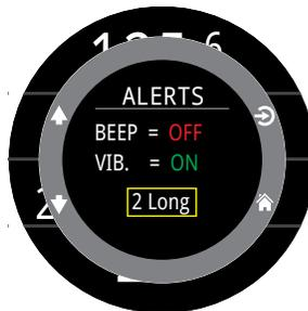
Le menu Dive Tools (Outils plongée) dispose également d'un outil Test Alerts (Test alertes), qui doit être utilisé de manière régulière avant les plongées pour vérifier le bon fonctionnement du bipueur et du vibreur.
