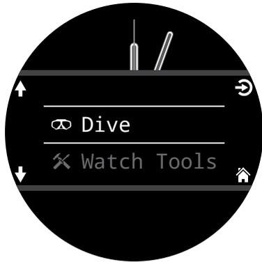
Pour passer manuellement du mode Watch (Montre) au mode Dive (Plongée), appuyez sur le bouton Menu et sélectionnez Dive (Plongée) dans le menu principal.
